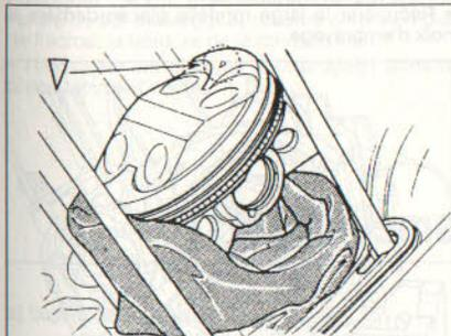
La flèche sur la calotte des pistons doit être dirigée vers l'avant de la moto (Côté échappement). Mettre un chiffon afin d'obstruer le carter moteur lors de l'installation des clips de maintien des axes de pistons
