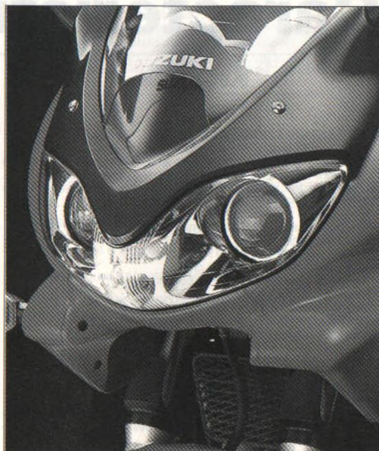
△ Le modèle GSF 600 S dispose d'une double optique lenticulaire. La vitre de protection avant avec sa forme complexe surmontée dans habillage noir permet d'affirmer encore plus la silhouette de la machine
